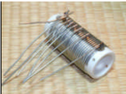
写真 37: タップ出しを終えたタンクコイル L4。線材は 2mmφのスズメッキ銅線。
