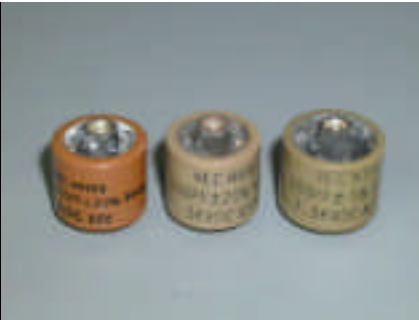
写真 14: プレート側補助コンデンサに使用した HH58。5KV 耐圧の表示が見える。
