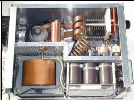
写真 2: ファイナルボックスの上蓋を外した様子。マルチバンド化でタンク回路が膨らむため、高圧ケミコンに低背型を採用しスペースを確保した。
