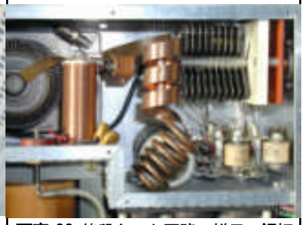
写真 33: 終段タンク回路の様子。銅板の 50MHz コイルは、最終的に 8mm 中の銅パイプに変更した。
