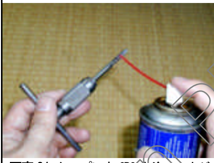
写真 31: タップにも CRC を塗ってネジを切り易くする。
