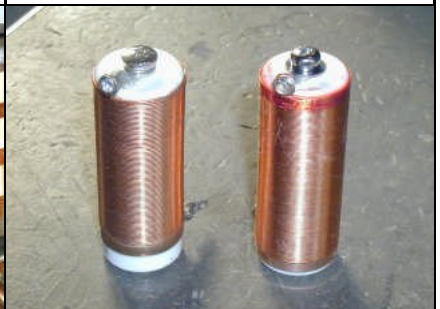
写真 12: プレート RFC、試作した回数は10本にも及ぶ。ポピンが短いので、分割巻が出来ない。
