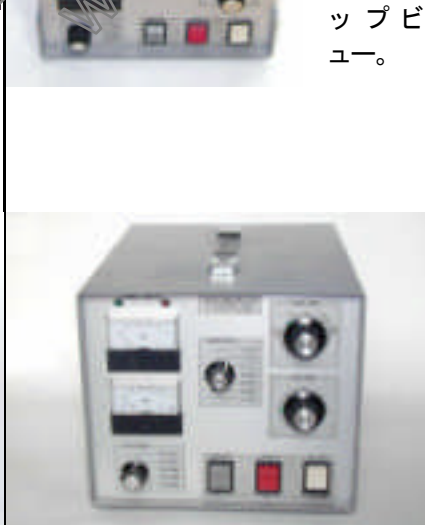
写真 47: フロントビュー。バンドスイッチを中央に配し、均等な重みを付け周辺レイアウトを決めた。
