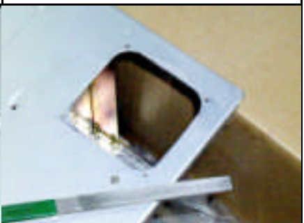
写真 24: ヤスリで面取りして完成。丸穴を開けるより簡単に出来る。ダンボール箱で作業すれば、周辺を汚さない。単身赴任の 6 畳間でも作業 OK
