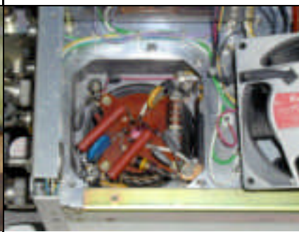
写真 35: 1 次ファンを外して、真空管のソケットを覗く。このように簡単にメンテナンスが出来る。
