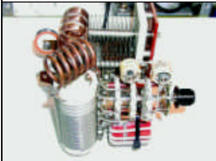
写真 16: タンクコイル・バンドスイッチ・VC 群が一体となった、π ネットワークブロック。この形で取り外しが可能。
