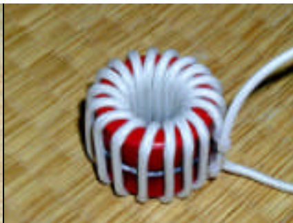
写真 38: カーボニルコアにシリコンガラス線巻いたL5。写真は2段だが、最終的に3段のスタックになった。
