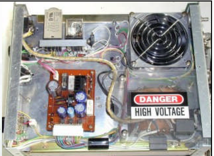
写真 3: 基板は低圧電源。右上は1次ファン、その左はスタンバイとタイマーリレー。高圧部はアクリル板で覆う。シャシ内では高周波は扱わない。
