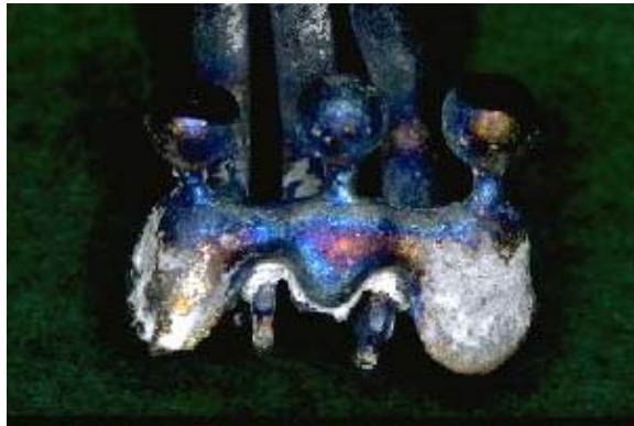
Fig. 23 鑄造チャンパー内の汚染や不適当な溶解雰囲気下ではチタンの純度を落とす
