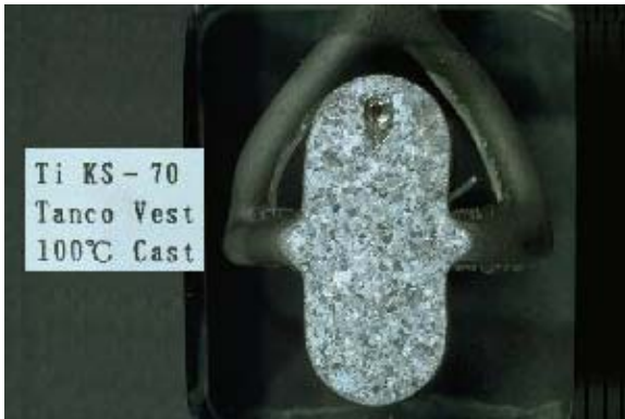
Fig. 13 負圧部となるように湯だまりの設置が望ましい
