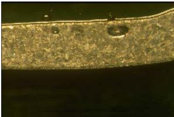
Fig. 14 太いスプリーを遠心力に直角に用いたほうがよい
