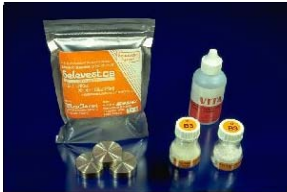
Fig. 2 マテリアルで純チタン(KS50),チタン専用埋没材,ビタ・チタン専用陶材とその専用液
