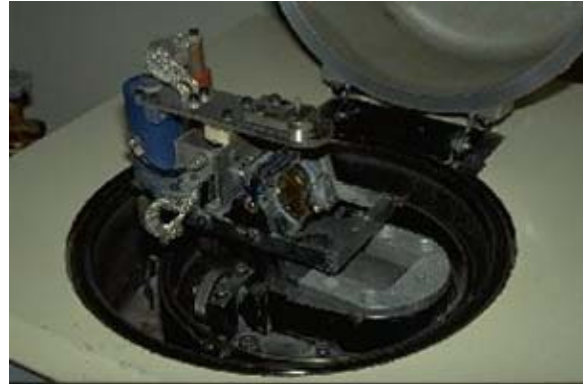
Fig. 19 炭素電極が傾注した状態
