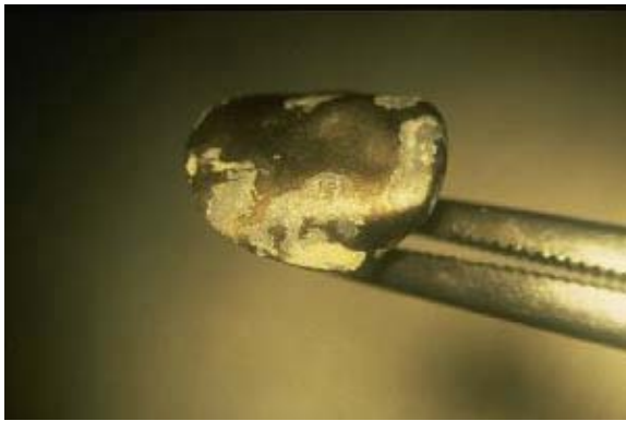
Fig. 8 チタン表面処理の不備による剥離
