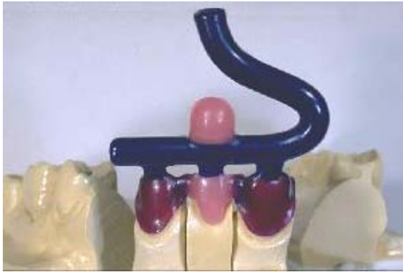
Fig. 12 スプリーの形態は,湯だまりに鑄巢を集める
