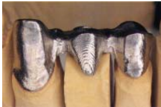
図 3 2 適合させたときの状態。支台歯の加工はラジアルで、ポンティックは時間短縮のため平行加工とし、その後は手作業とした。NC 加工設定時の切り込み、深さ、送りなどや切削時のバーの直径などによって適合の度合が異なる。
