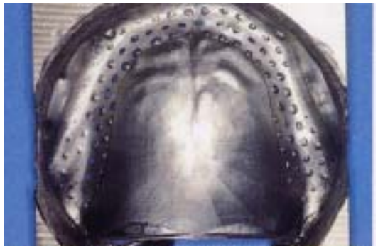
図 5 1 粗加工の終了した状態。所要時間 17 時間 55 分。
