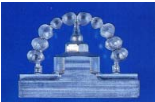
図14 10歯連続の加工物。こうしたカーブした歯列弓でも、加工のフローチャートによって切削が正確に行なえる。ただしこのケースは、切削しやすいアルミニウム試材である。
