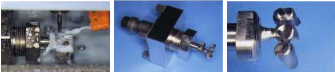
図 2 8 チタンの角柱から粗加工の切削を開始している状態。注切削水は錆止めタイプで循環式である。
