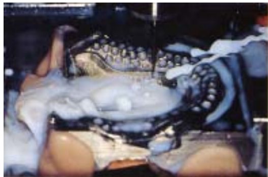
図 5 0 粗加工は、注切削水下で超硬工具 3mm で回転数 20,000rpm で行なった。このとき、維持部のスケルトンから切削を行なった。
