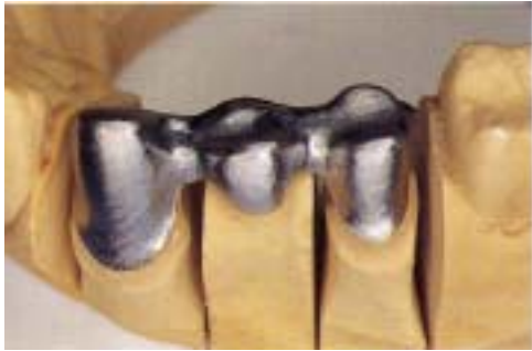
図35 CNC加工後の形態修整の仕上げ。こうした微妙な焼付の技術は、ベテランの歯科技工士の作業となる。
