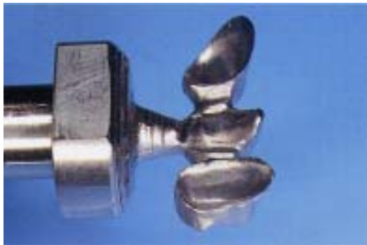
図 3 1 支台歯側の粗・中間・仕上げ加工は、注切削水下で超硬工具/回転 2 0, 0 0 0 rpm で行なった(粗加工:工具 3 mm、所要時間 1 時間 4 2 分。中間加工:工具 1 mm、所要時間 4 時間 5 分。仕上げ加工:工具 1 mm 所要時間 4 6 分)。
