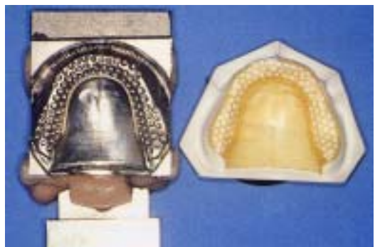
図 5 2 仕上げ加工の終了した状態とパターンモデルと模型。仕上げは、注切削水下で超硬工具 1mm で回転数 20,000rpm で行なった。所要時間 5 時間 10 分。
