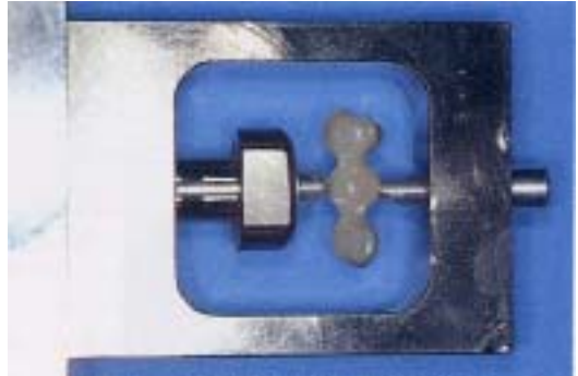
図19 計測圧によるモデルのたわみを軽減させるため、2方向から固定する。
