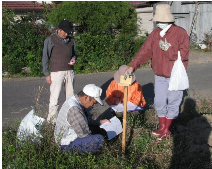
簡易放射能測定器 ホリバ PA-1000Radi 使用
