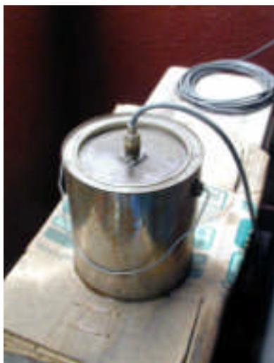
写真 21 : ベランダに置いた油冷ダミーロード
