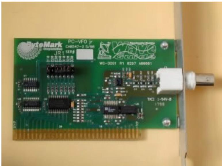
PC-VF0jr の ISA ボード。出力は BNC から取り出す。JP でポートアドレスを設定し、同じアドレスをソフト上でキー入力するだけで使える。SG としても使用できる。
