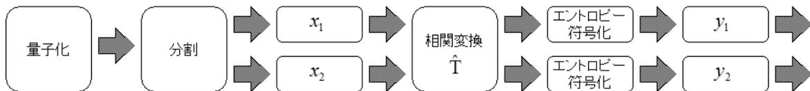
図 2.2: 相関変換法による Multiple Description 符号化の手順
