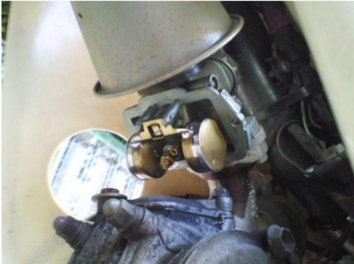
現在エアスクリュー 1 + 1/2 戻し ピン位置は 4 段目 (標準より一段薄い側) PJ # 35 MJ # 98。
