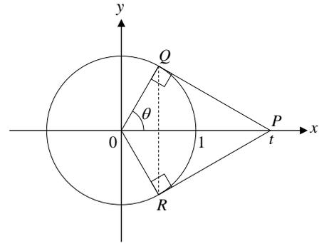
三角形  $PQR$  を  $x$  軸中心に回転してできる円錐は、底面の半径が  $\sin\theta$  である。
