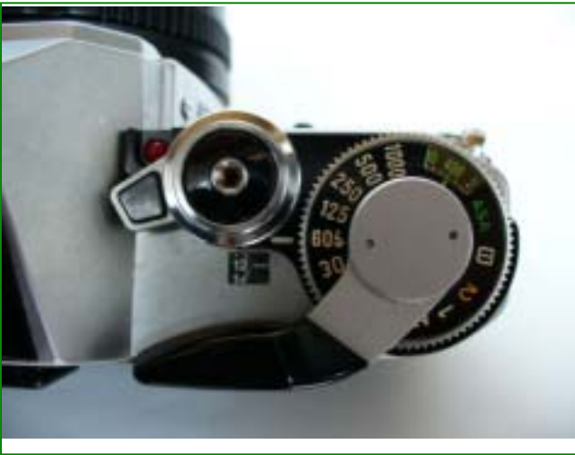
スイッチ ON 状態 (矢印の A にあわせる)
