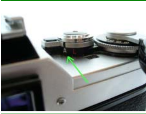
スイッチ ON 状態 (矢印の A にあわせる)
