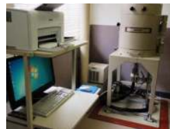
Ge半導体検出器で 137 Cs濃度 （Bq/kg-wet）を測定（2,000-36,000sec）
