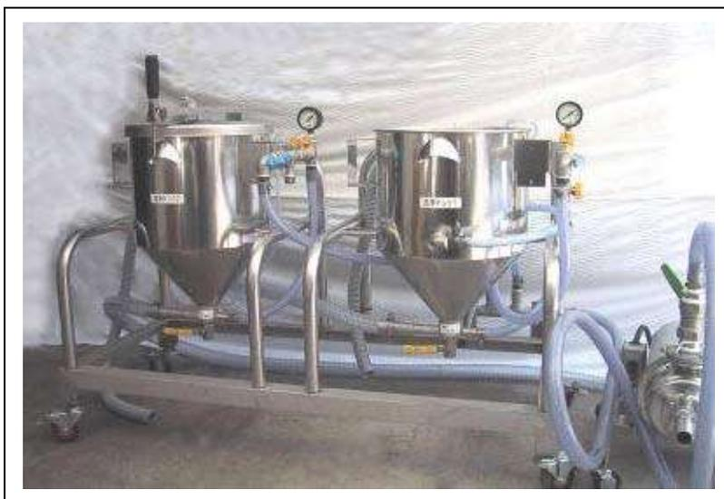
【しくみ】1槽目（写真右）に連続的に白米を投入、1槽目の下部でジェットにあたり2槽目（写真左）に流送。2槽目に入り糠と分離し、2槽目の下部でジェットにあたり流送。槽の中を循環しないしくみのため連続洗米になります。
